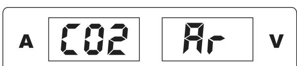
После выбора типа защитного газа нажмите на регулятор поз.8 еще раз для подтверждения выбора, на экране появится надпись «-- --».
