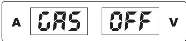
Вращая регулятор сварочного напряжения, установите требуемое значение времени продувки защитного газа.
