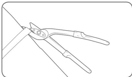
Уст новите ножницы н ленту, чтобы он ок з л сь между опорным лезвием и з щитным упором.
