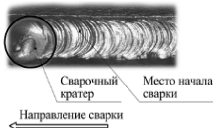
Рис. 9.2. Начало сварки при смене электрода.
