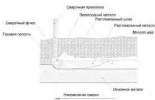
Рис. 8.14. Формирование сварочной ванны при сварке под флюсом.
